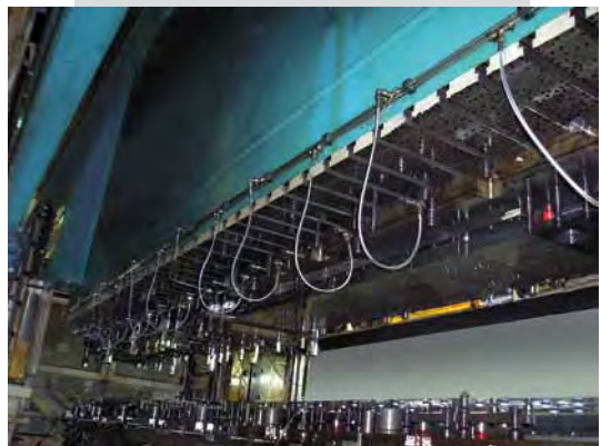
Spannelemente an einer Transfer-Großpresse der Fa. Schuler.
