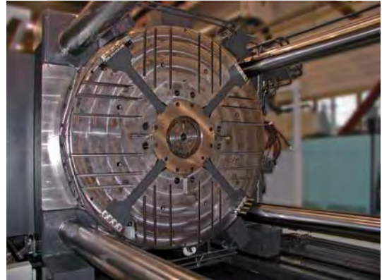
Verriegelungs-Blockzylinder für Drehscheibe, Temperaturbereich max. 70°C.
